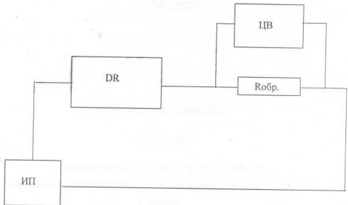
Схема соединений при поверке цифрового термометра "DIWITHERM"
